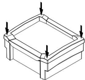
Der Frontrahmen BCD\_FO- wird aufgesteckt und an 4 Stellen geklemmt.
