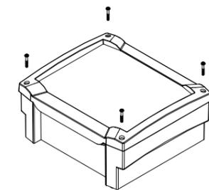
Der Deckel BCD\_OT-F- wird mit 4 Schrauben befestigt.
