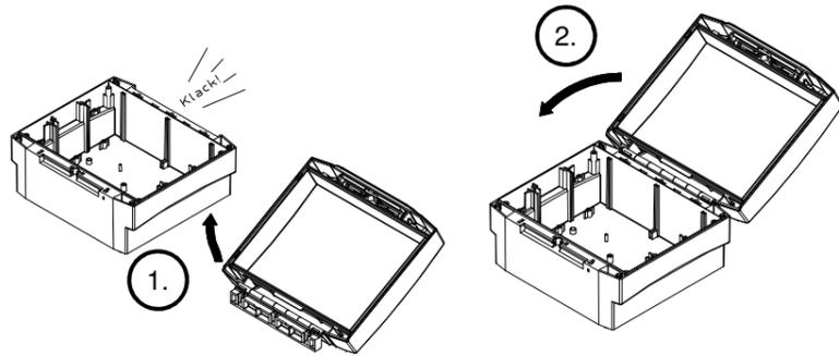
Das Scharnier wird an das Unterteil (UT) gerastet (1.). Der Deckel (OT-G-) wird anschließend durch zuschwenken geschlossen (2.).
