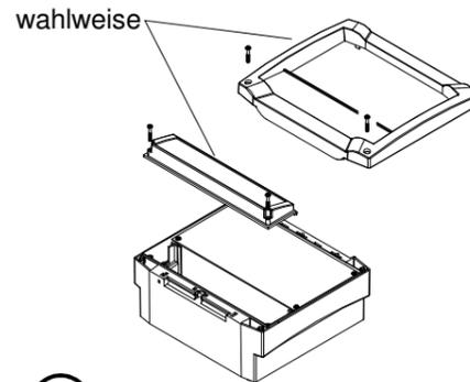
3. Klemmenraumdeckel (BCD-\_\_-KRD-) oder Frontrahmen mit integriertem Klemmenraumdeckel (BCD-\_\_-FO-K-) montieren. Der Klemmenraum kann dabei wahlweise oben oder unten positioniert werden (4.).
