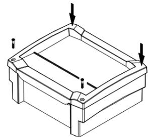
Der Frontrahmen BCD\_FO-K- wird aufgesteckt, an 2 Stellen geklemmt und am Klemmenraum verschraubt.
